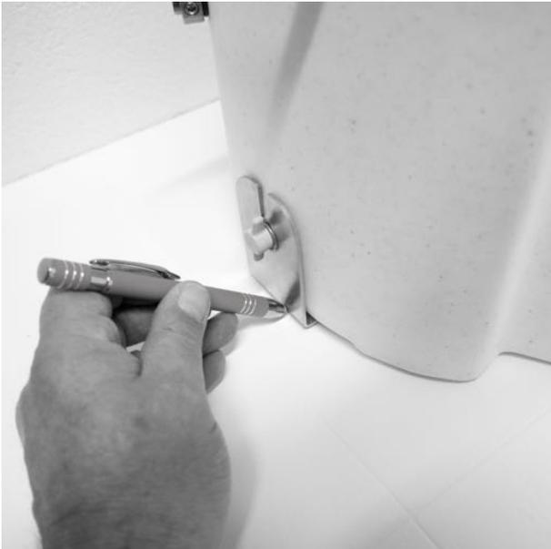
Montieren Sie den Feststofftank und befestigen Sie ihn mit den Rändelschrauben.
