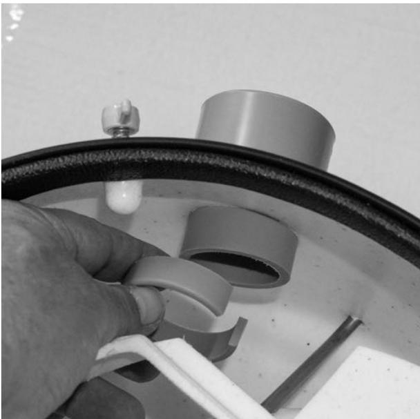
Verkleben Sie die beiden Teile mit einem geeigneten Klebstoff, z.B. UHU Weich PVC Kleber. Die Manschette sollte gerade so locker sein, dass sie sich noch leicht drehen lässt.
